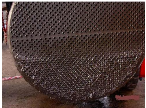
図 1 3. 汚れた AES 型 VDU/供給熱交換器の調査
